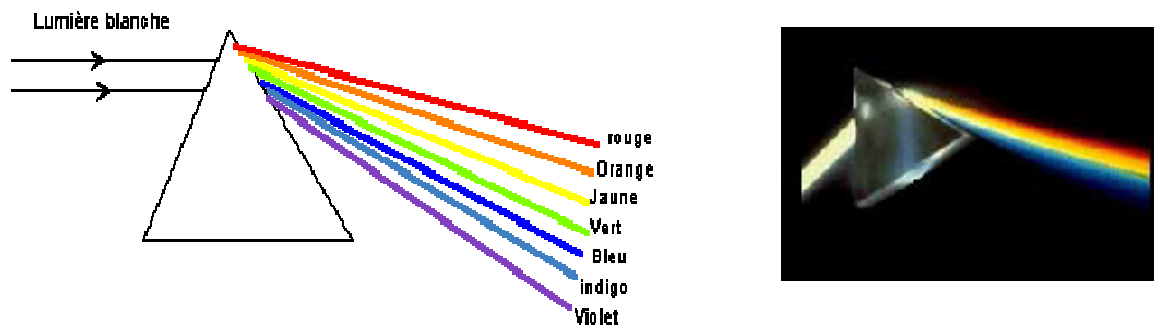
Figure6. Dispersion de la lumière par un prisme
